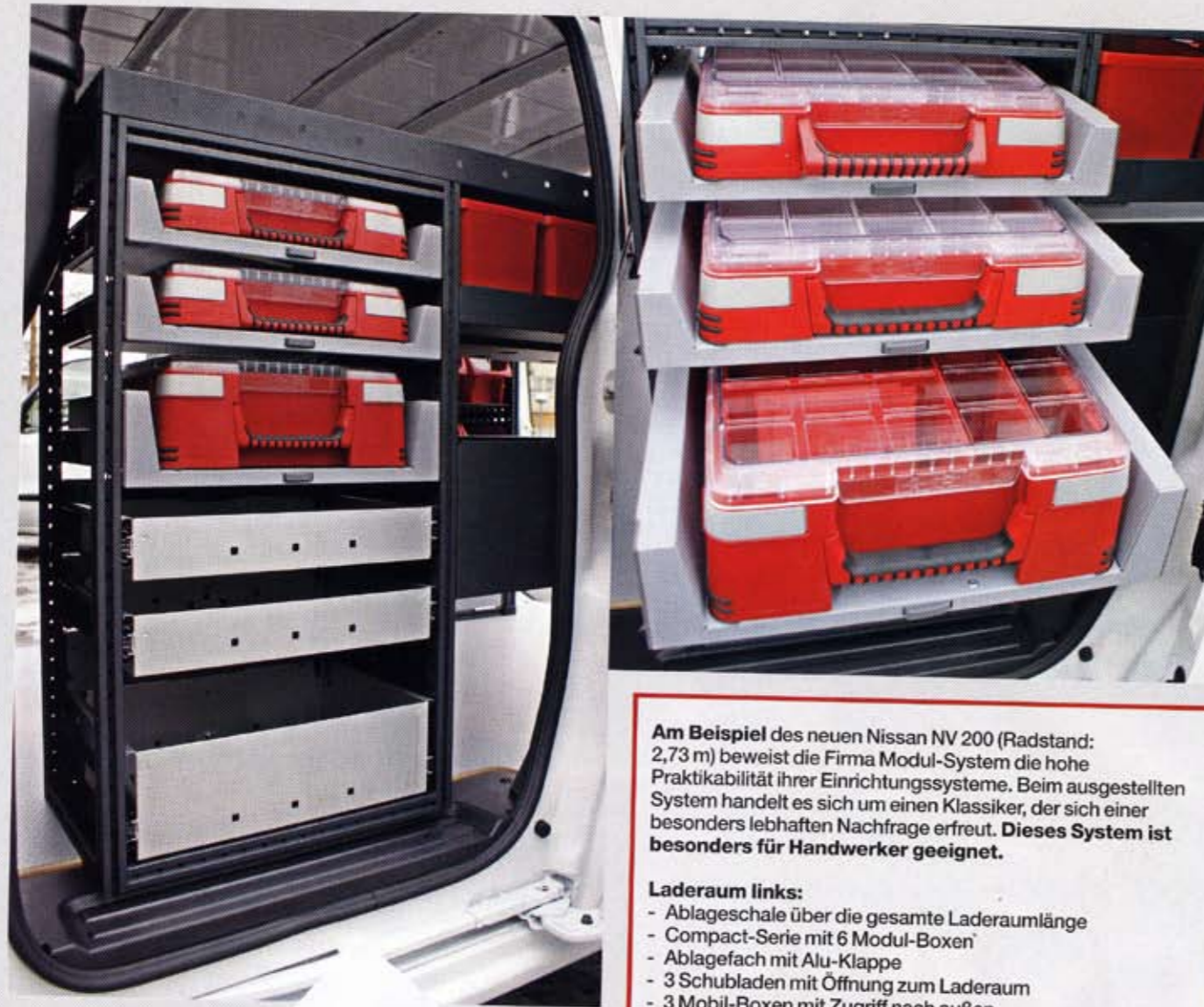
Ausbaubeispiel: Nissan NV 200
